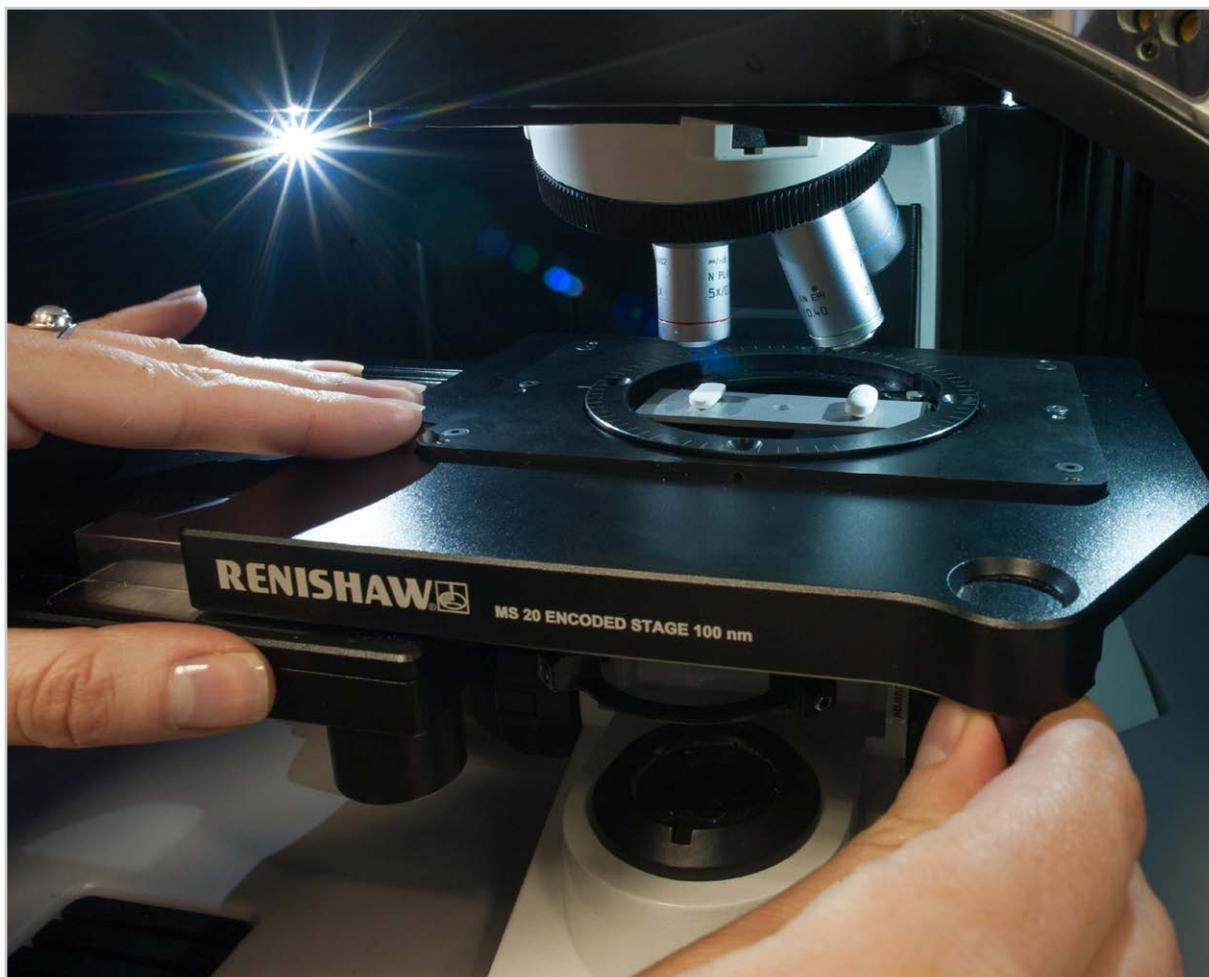
La plataforma motorizada patentada por Renishaw utiliza encóderes para realizar el seguimiento de su posición, incluso cuando se mueve de forma manual.
