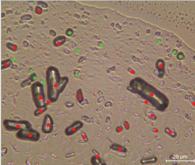
Mapa de puntos discretos; análisis rápido y específico de partículas individuales de una gota de spray nasal. La imagen revela la localización del medicamento y el excipiente en la imagen de luz blanca.
