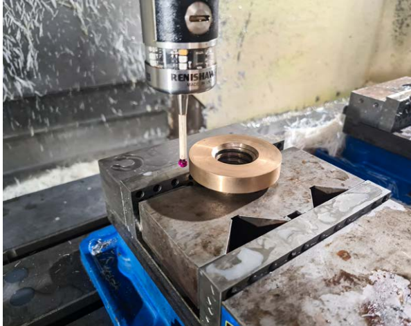
Munkadarabok beállítása és ellenőrzése a Renishaw OMP40-2 optikai jelátvitelű tapintófejével.
