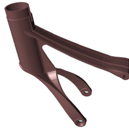
1. CAD-model van zadelpen, ontworpen voor gieten met aluminiumlegering
