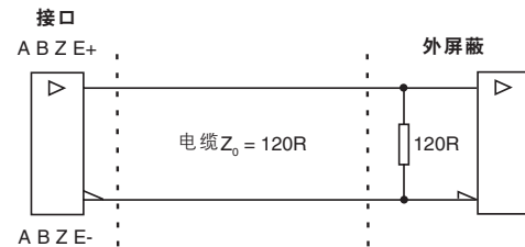
标准 RS422A 线接收器电路
