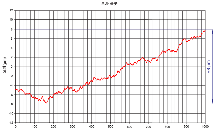
길이 1000 mm의 RTLA50 스케일에 대한 정확도 테스트 결과 예시
