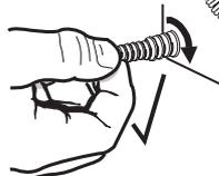
Federdurchführung über Druckluftanschluss aufschrauben
