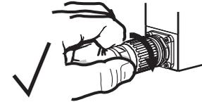
3. Überwurfmutter nach rechts drehen, um Verbindungsstück zu verriegeln.
