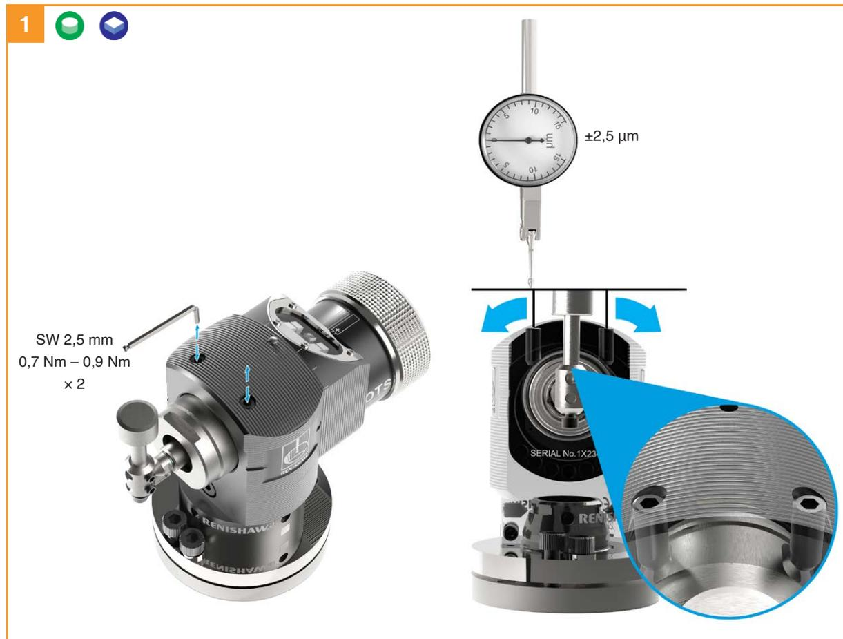
Die seitliche Ausrichtung erfolgt durch abwechselndes Einstellen der Gewindestifte. Dadurch dreht sich das Messtastermodul und verändert die Einstellung des Tastereinsatzes.
